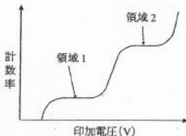
比例計数管は、( C6)により、放射線による信号をノイズに比べ十分に大きくできるため、領域1で得られた計数率からバックグラウンド計数率を差し引いた正味の計数率は、面線源から放出される(ホ1)の( D9)に相当する。
